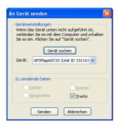
Falls kein Gerät angezeigt wird, "Gerät suchen" anklicken, dann "Senden" anklicken.
